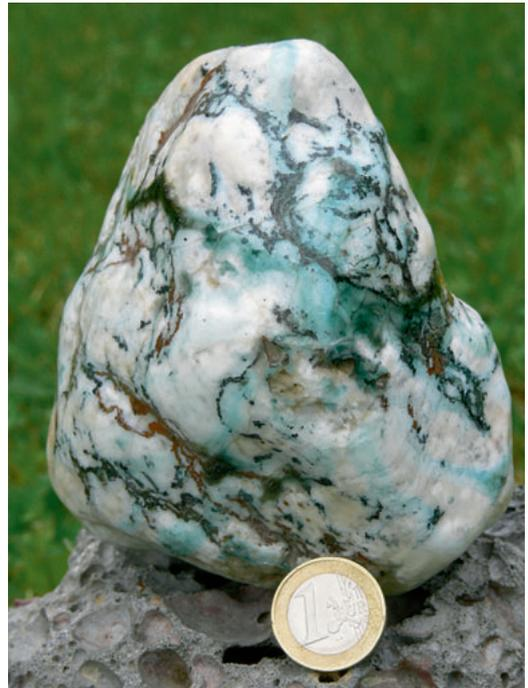
Abb. 4. Die »Kalkbrenner von Otting« (zwischen Traunreut und Palling) heizen alle fünf Jahre einen mittlerweile 300 Jahre alten Kalkofen an. Es ist fast unvermeidbar, dass nicht doch ein oder mehrere silikatische Gerölle in den Ofen geraten. Diese Silikatgerölle schmelzen während des Brandes oberflächlich an. Manche beginnen weich zu werden und zerscheren. Im Bild ein Gangquarz-Geröll mit grünlichem Glasüberzug aus dem Kalkbrennofen von Otting.
