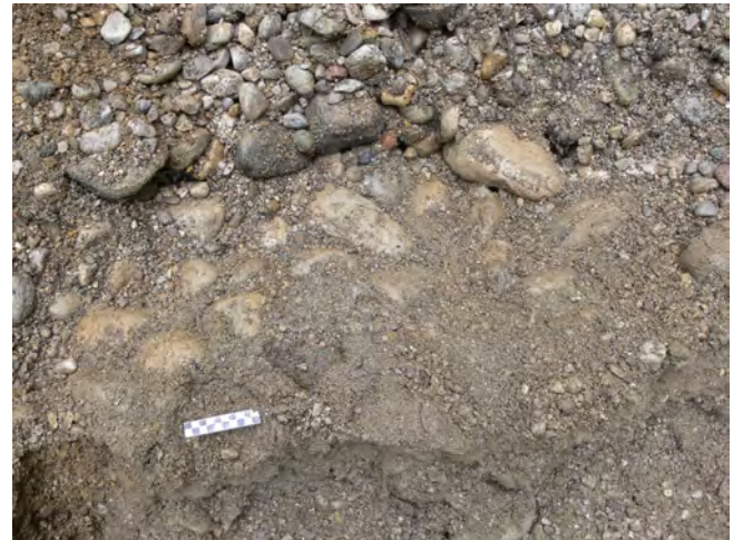
Abb. 9. Freigelegtes Profil im „Kies“ des Probenpunktes TS4 am Westrand der Oberen Tüttensee-Terrasse II. Von unten nach oben: sandiger Feinkies, Sand, Steinlage, matrixfreier Kies.
