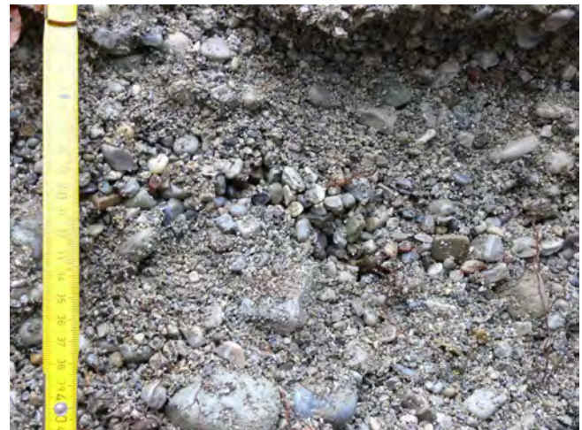
Abb. 11. Gleicher Aufschluss wie in Abb. 10. Der ca. 20 × 20 cm große Ausschnitt lässt erkennen, dass dieser Kies grob geschichtet ist. Die mittelmäßige Lage, welche die Bildmitte ungefähr horizontal durchzieht, zeigt matrixfreie Räume zwischen den Geröllen.
